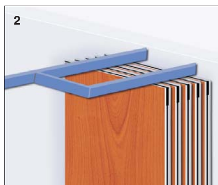
2 Elementid on varustatud kahe ratastikuga, teine ratas jääb põhijuhiku alale.
