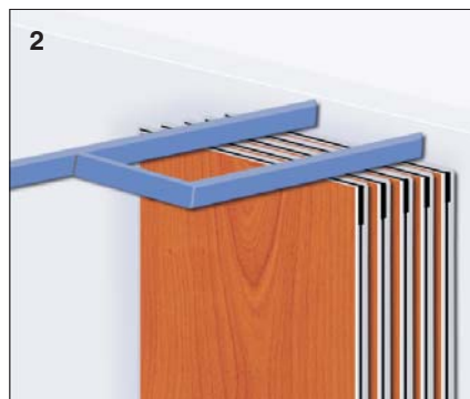
2 Elementid on varustatud kahe ratastikuga, teine ratas jääb põhijuhiku alla.
